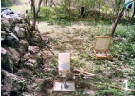
Foto 1 – Ensaio da densidade “in situ” utilizando o frasco de areia com densidade conhecida.
