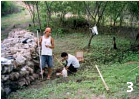
Foto 3 e 4 – Aferição das áreas e volumes dos sedimentos acumulados nos microbarramentos BA02 E BA03.
