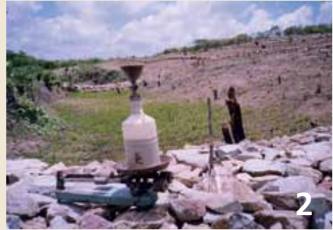
Foto 2 – Pesagem do frasco após preenchimento da cavidade no solo.
