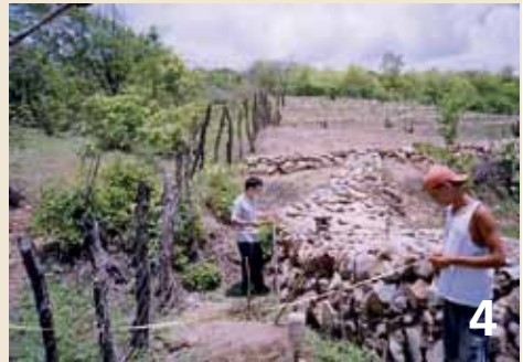
Foto 3 e 4 – Aferição das áreas e volumes dos sedimentos acumulados nos microbarramentos BA02 E BA03.
